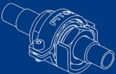
将扣环上的螺钉拧入轴环上的螺纹孔，用 3 mm 六角扳手拧紧。
