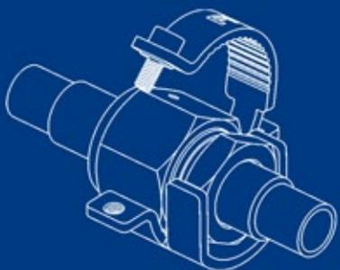
将扣环上的突出插入轴环上的槽口，调整扣环与轴环和螺母匹配。
