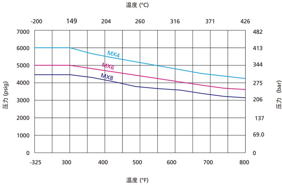
系统中压力波动、震动或脉冲的峰值不能超过所选软管额定工作压力的50%。
