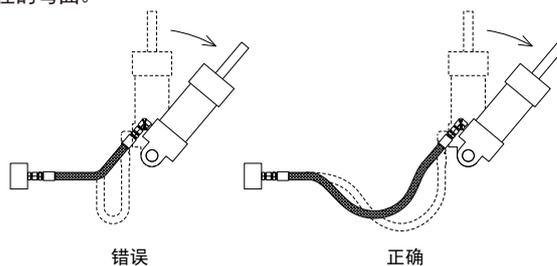
使用弯头连接的软管比使用直接头连接的软管更适合垂直移动。
