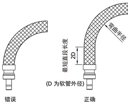
弯曲部分需保证最短直段长度，弯曲部分过于靠近软管/接头连接位置可能会导致软管破裂或泄漏。
