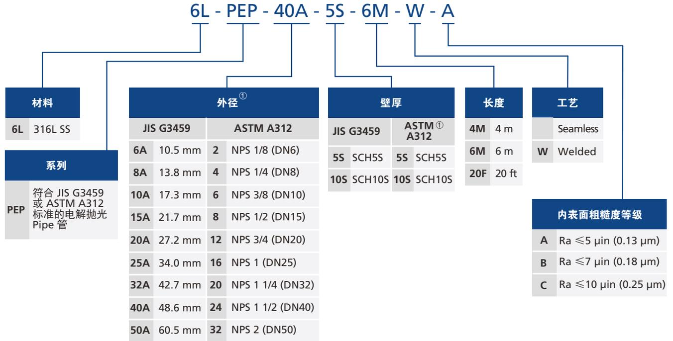
① 壁厚参照 ASME B36.19M，如需参照 ASME B36.10M，请咨询 FITOK。
